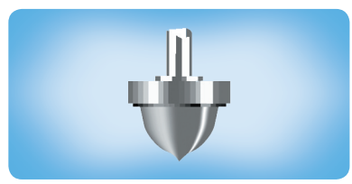
parabelförmiger Ventilstößel ermöglicht hubproportionale K_v -Änderung
